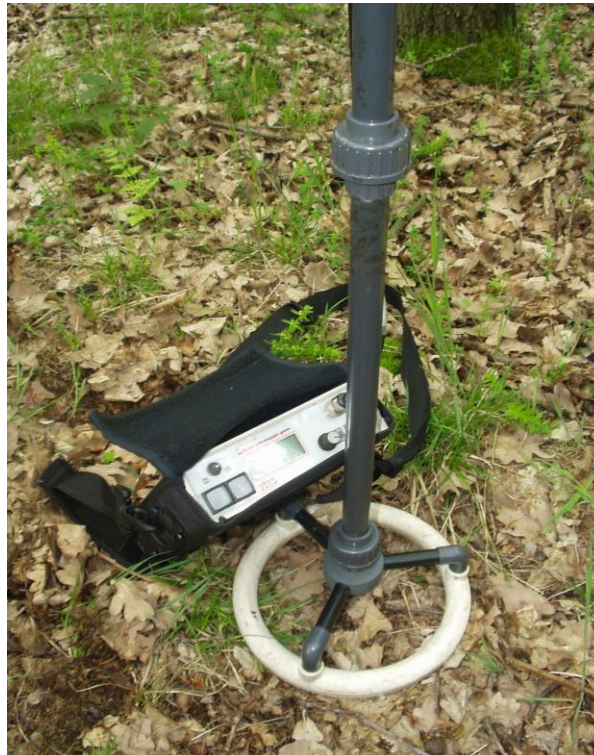
Fot. 14.2. Miernik pionowej podatności magnetycznej (fot. A. Czerniak)
