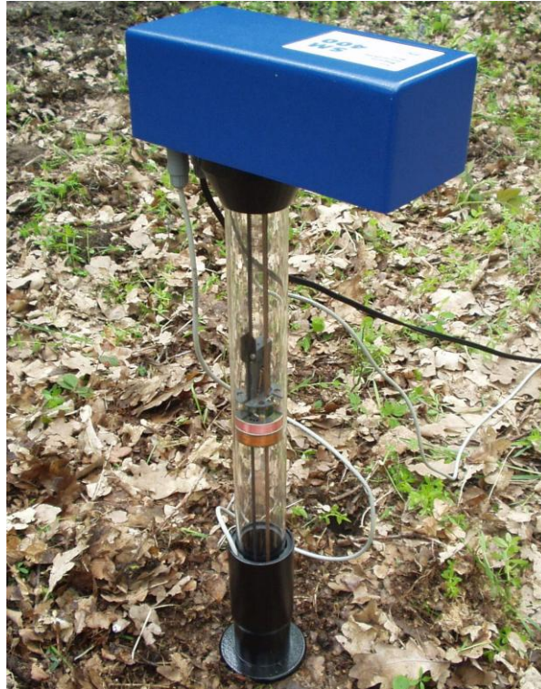
Fot. 14.1. Czujnik do pomiaru powierzchniowej podatności magnetycznej (fot. A. Czerniak)
